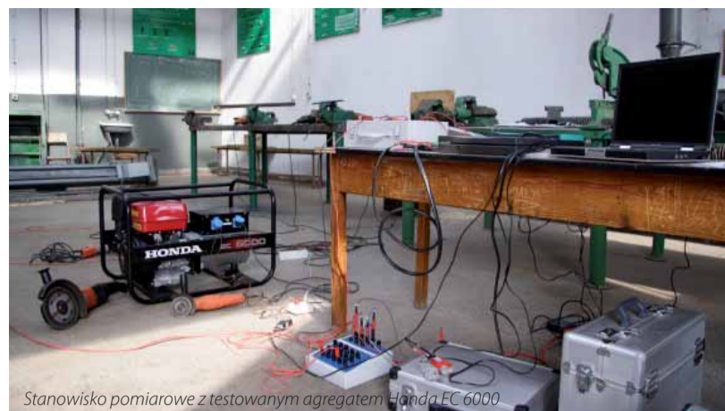
Stanowisko pomiarowe z testowanym agregatem Honda EC 6000
