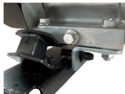
Ryzyko zerwania amortyzatorów w czasie ekstremalnego użytkowania agregatów serii EG zmniejsza tzw. stoper antywstrząsowy
