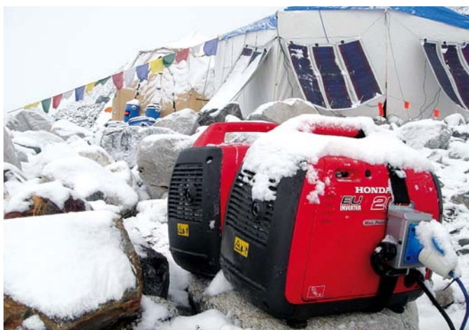
Połączone szeregowo dwa agregaty Honda EU20iS
